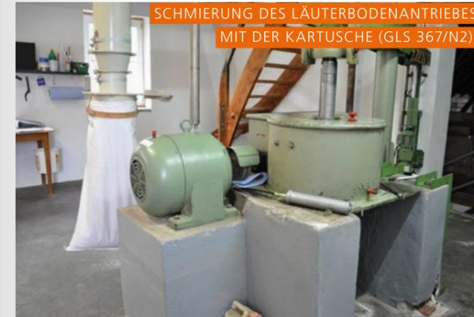
SCHMIERUNG DES LÄUTERBODENANTRIEBES MIT DER KARTUSCHE (GLS 367/N2).
