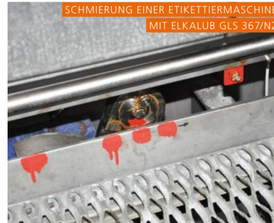
SCHMIERUNG EINER ETIKETTIERMASCHINE MIT ELKALUB GLS 367/N2
